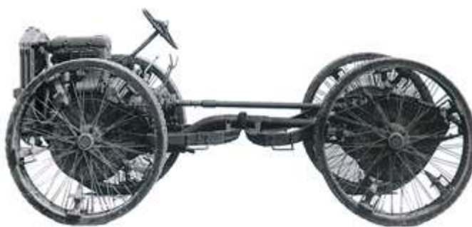
Шасси Pavesi 1926 года из первой партии. Машина с узкими колесами.
